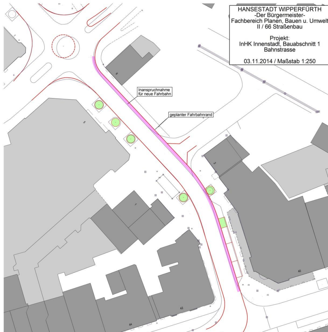
InHk Wipperfürth, Ausbau Bahnstraße Fahrbahnverbreiterung auf östlicher Seite
